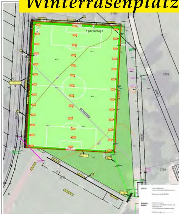
Der in den Jahren 1980 bis 1983 in Eigenregie gebaute Trainingsplatz wird saniert und nach dem Einbau von neuen Drainagen zu einem Winterrasenspielfeld. Im Zuge der Sanierung werden auch die Ballfangzäune erneuert.
